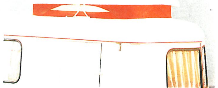
Ideale Lüftungsverhältnisse beim Sommer- und Wintercamping garantiert der bewährte ERIBA-Schnellschluß-Hublüfter.
