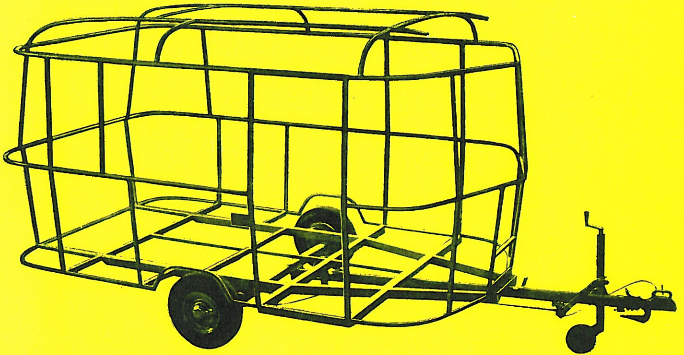
Jeder ERIBA mit verwindungsfestem Stahlrohrgerippe
