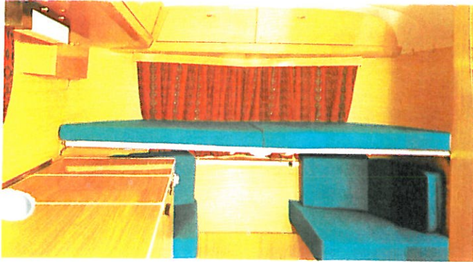
Das Zusatzbett, auf Wunsch für die Bugsitzgruppe lieferbar, ist zusammenklappbar wie die Polsterauflage. Eine Sturzblende verhindert das Herausfallen.
